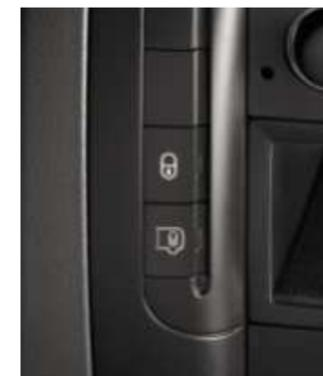
De sa place, le conducteur verrouille ou déverrouille l'ensemble du véhicule, seulement la cabine avant ou, encore, uniquement le compartiment arrière.
