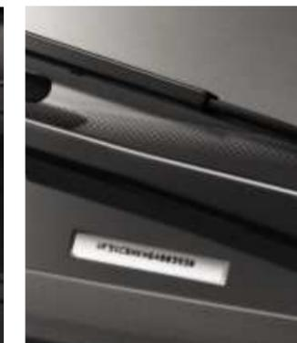
Pour faciliter l'identification de votre Expert, son numéro de châssis figure, gravé, sur la tôle d'auvent en bas du pare-brise.
