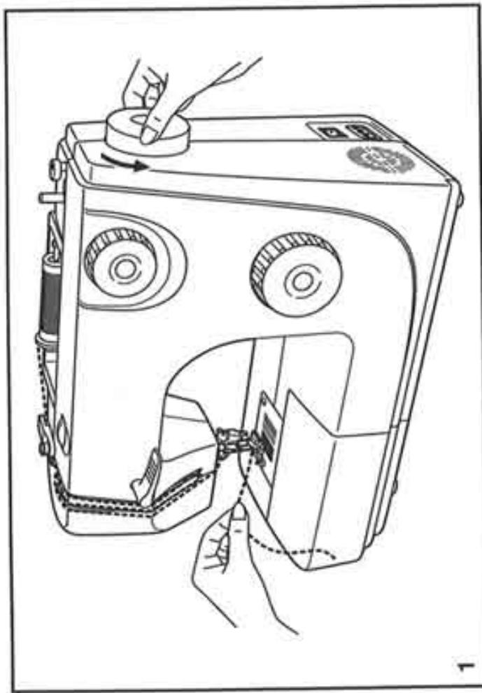
Tirez doucement sur le fil supérieur pour faire remonter le fil de canette à travers le trou dans la plaque à aiguille. (2)
