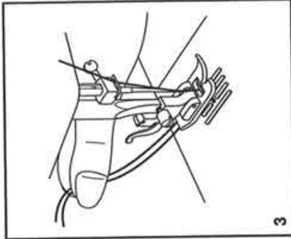
Passez les deux fils en dessous du pied presseur et placez-les vers l'arrière de la machine. (3)
