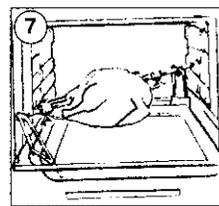
⑧ Faites basculer l'ensemble broche/support de façon à faire pénétrer la pointe de la broche dans le carré d'entraînement situé au fond sur la partie droite du four.
