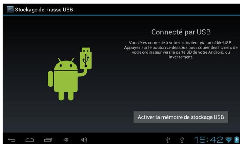
Lorsque la tablette est connectée en USB à votre PC le menu stockage de masse USB s'ouvre. Appuyer sur « Activer la mémoire de stockage UBS » pour pouvoir transférer des données. Appuyer sur « Désactiver la mémoire de stockage USB » pour arrêter le mode de Stockage de masse USB.
