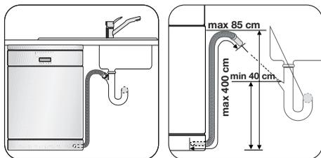
**1** Raccordez le tuyau de vidange au robinet de sortie de l'évier.
