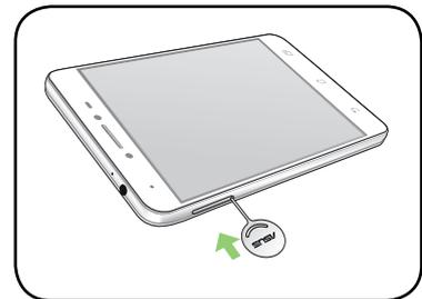
3. Entfernen Sie die MicroSD-Karte aus dem Nano-SIM- / MicroSD-Kombi-Kartensteckplatz.
