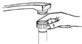
Raccordez le tuyau d'arrivée d'eau froide à un raccord fileté 3/4 et assurez-vous qu'il soit bien serré.
