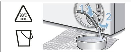
5. Dévissez délicatement le bouchon de la pompe ; de l'eau résiduelle peut s'écouler. Nettoyez le compartiment intérieur, le filetage du couvercle de pompe et le carter de pompe. Le rotor de la pompe de vidange doit pouvoir tourner librement. Remettez le couvercle en place et vissez-le. La poignée doit se trouver à la verticale.
