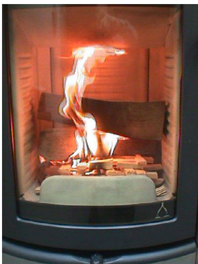
III. 3: Chiudere la presa dell'aria primaria
