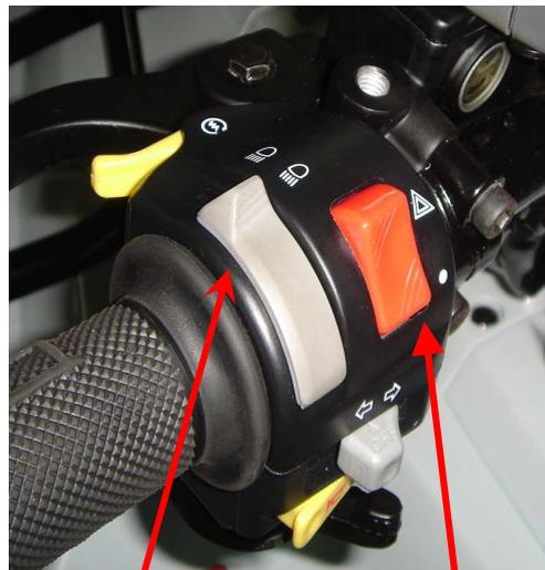
Interrupteur de faisceau H/B
