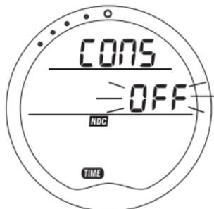
Fig. 64 - Réglage de la marge de sécurité
