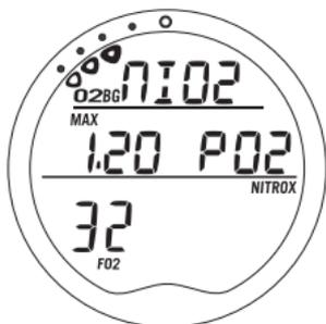
Fig. 76 - Paramètres oxygène
