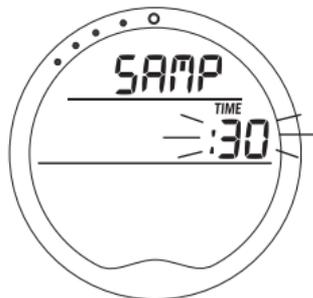
Fig. 66 - Réglage de la fréquence d'échantillonnage
