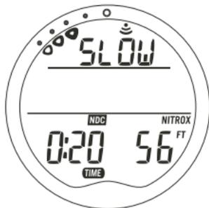
Fig. 83 - Alarme d'approche de vitesse de remontée max
