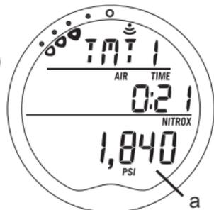
Fig. 28 - Pression de la bouteille
