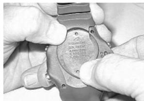
Fig. 118B - Démontage du compartiment pile (autre solution)
