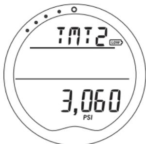
Fig. 6A - Etat de la pile émetteur 2 (faible)
