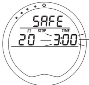
Fig. 63 - Réglage du palier de sécurité
