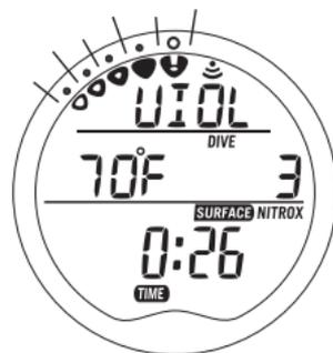
Fig. 101 - Mode Profondimètre après infraction (en surface).
