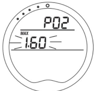
Fig. 59 - Réglage de l'alarme de PO2
