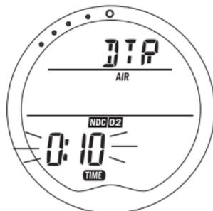
Fig. 56 - Réglage de l'alarme de temps de plongée restant
