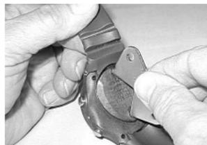
Fig. 118A - Démontage du couvercle de l'ATOM
