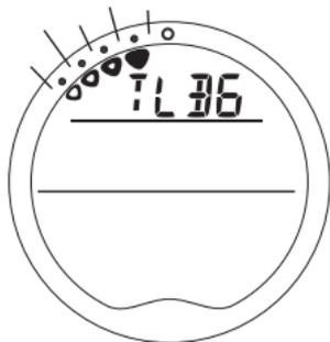
Fig. 55 - Réglage de l'alarme d'indicateur d'absorption d'azote
