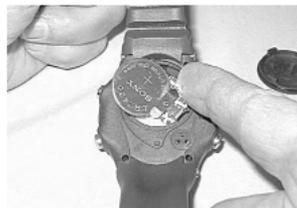
Fig. 119 - Dépose de la pile de l'ATOM
