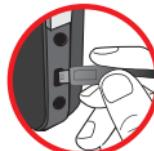
! Quando utilizar um PC para carregar a bateria, não ligue a câmara pois se o fizer o carregamento será interrompido.
