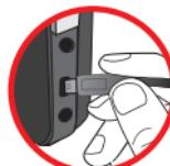
! Lorsque vous utilisez un PC pour charger la batterie, n'alimentez pas le caméscope, sinon la charge s'arrête.
