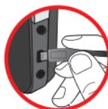
! Podczas wykorzystywania komputera do ładowania baterii, nie należy włączać kamery lub zatrzymane zostanie ładowanie.
