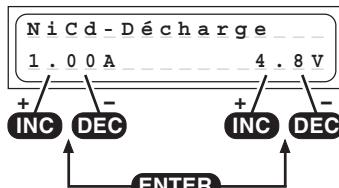
Ce programme sert par ex. pour déterminer la capacité restante ou pour définir la décharge d'un accu d'émission, de réception ou de propulsion.
