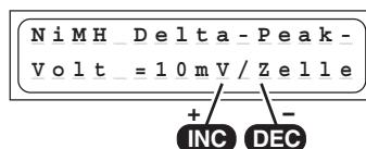
Die Ansprechspannung (in mV pro Zelle!) der Abschaltautomatik für NiMH-Akkus kann eingestellt werden. NiMH-Akkus haben gegenüber NiCd-Akkus einen weniger ausgeprägten Spannungsrückgang. Als praktikabel haben sich Spannungseinstellungen von 5 ... 25mV/Zelle herausgestellt. Höhere Spannungen führen häufig zur Überladung der Batterie, niedrigere Spannungen führen oft zu Frühabschaltung.
