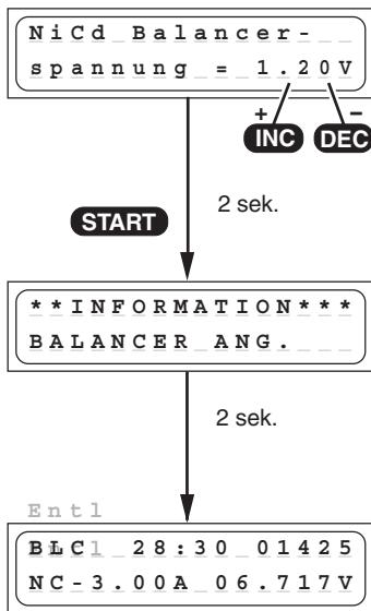
Dieses Programm dient zur Angleichung der Zellenspannungen der einzelnen Akkuzellen für Akkupacks mit 2-6 Zellen.
