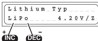
Die Einstellung des Akkutyps (LiPo, Lilo oder LiFe) beeinflusst die Abschaltspannung. Sollte ein Lithium-Akku wider Erwarten nur zu 2/3 aufgeladen werden, so haben Sie vielleicht hier den falschen Akkutyp eingestellt.
