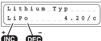
L'impostazione del tipo di accumulatore (LiPo o Lilo o LiFe) determina la tensione di spegnimento. Se un accumulatore al litio viene caricato solo per i 2/3 dell'aspettativa, probabilmente avete sbagliato, in questa sede, l'impostazione del tipo di accumulatore.
