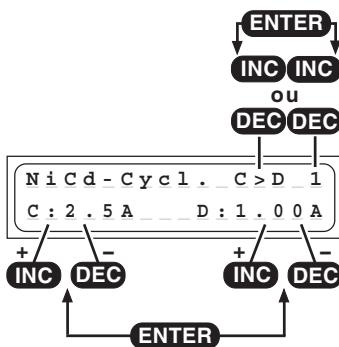
Ce programme sert pour l'optimisation de la capacité et le cyclage d'une batterie.
