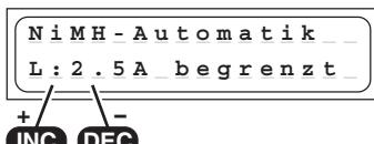
In diesem Programm erkennt das Ladegerät den angeschlossenen Ni-Mh Akkutypen und passt den Ladestrom dementsprechend an, sodass eine Überlastung des Akkupacks verhindert wird.
