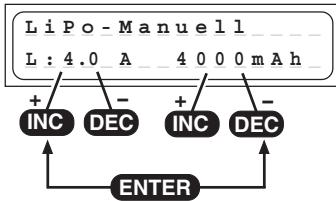
Bei diesem Programm wird der Akku mit dem eingestellten Ladestrom aufgeladen.
