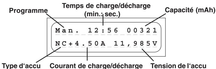
Durant la charge/décharge, des données importantes seront clairement lisibles sur l'affichage à cristaux liquides à deux lignes jusqu'à la dé connexion de l'accu. Avec la charge d'un autre accu, les valeurs précédemment affichées ne seront plus appelables.
