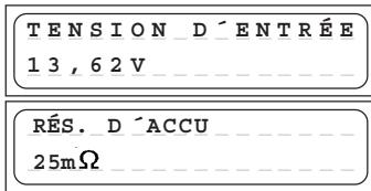
Le tension d'entrée et la résistance actuelles de l'accu pourront être appelées à tout moment en pressant **simultanément** les touches INC et DEC. Par la pression des touches INC ou DEC, l'affichage s'échange pour la résistance interne, les tensions séparées d'éléments ou pour la tension d'entrée.
