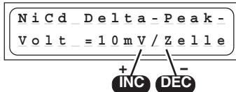
Die Ladeabschaltautomatik (Akku-Vollerkennung) arbeitet nach dem millionenfach bewährten Delta-Peak-Verfahren (auch bekannt als Delta-U- oder Delta-V-Verfahren). Dieses Verfahren wertet das Spannungsmaximum der Ladekurve aus, welches recht genau das Erreichen des maximalen Ladungsinhaltes angibt.
