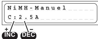
Avec ce programme, l'accu sera chargé avec le courant de charge réglé.
