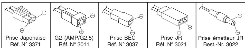
Utiliser uniquement des cordons de charge originaux avec des fils d'une section suffisante.
