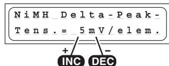
La tension d'intervention (en mV par élément) de la coupure automatique pour les accus NiMH pourra être réglée.
