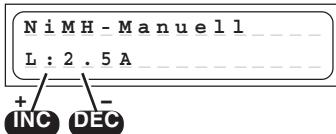
Con questo programma l'accumulatore viene caricato con la corrente di carica impostata. La corrente di carica massima può essere impostata con i tasti INC / DEC da 0.1 A a 5.0 A **prima** di collegare l'accumulatore. Il processo di carica termina in accordo con i valori impostati per la tensione di spegnimento del delta peak.
