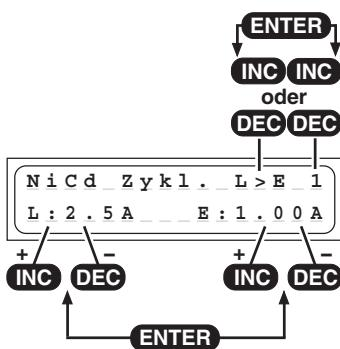
Dieses Programm dient zur Optimierung von Kapazität und Formierung einer Batterie.
