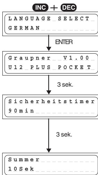
Drücken Sie die Tasten INC und DEC gleichzeitig, während Sie das Gerät mit der Eingangsspannung versorgen, um in die Sprachauswahl zu gelangen. Drücken Sie die Tasten INC oder DEC um die gewünschte Sprache ENGLISH, GERMAN (Deutsch) oder FRENCH auszuwählen. Verlassen Sie die Sprachauswahl mit indem Sie die Taste ENTER drücken.
