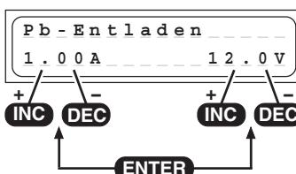
Dieses Programm dient z.B. zum Ermitteln der Restkapazität eines Antriebsakkus.
