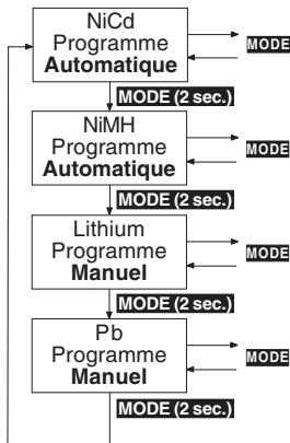
Les possibilités de charge et de décharge de le chargeur sont clairement et logiquement réparties dans les quatre groupes de programmes. Un groupe de programmes propre à chacun des différents types d'accu NiCd, NiMH, LiPo/LiPo/LiFe et **Pb (Plomb)** est à disposition. Un autre groupe de programmes permet des possibilités de réglage Programme individuelles du chargeur.
