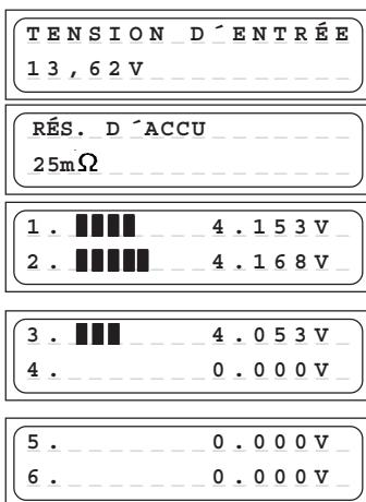
La tension d'entrée actuelle et la résistance interne de l'accu pourront être appelées à tout moment par la pression **simultanée** des touches INC et DEC. Par la pression des touches INC ou DEC, l'affichage s'échange pour la résistance interne, les tensions séparées d'éléments ou pour la tension d'entrée.
