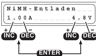
Questo programma è utile per es. per determinare la capacità residua oppure per la scarica dell'accumulatore di una trasmittente, di una ricevente o di alimentazione di un motore. Con questo programma viene effettuata la scarica con una corrente di scarica impostata (0.10 ... 1.0 A, a sinistra sul display) fino alla tensione finale di scarica (0.1 ... 16.8 V , a destra sul display).
