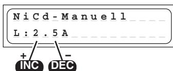
Bei diesem Programm wird der Akku mit dem eingestellten Ladestrom aufgeladen.
