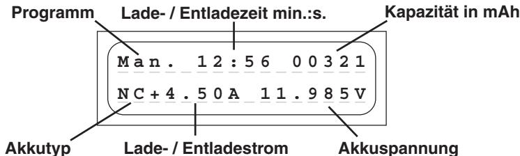
Die während der Ladung /Entladung wichtigen Daten werden übersichtlich auf der zweizeiligen Flüssigkristallanzeige wiedergegeben und sind bis zum Abklemmen des zu ladenden Akkus sichtbar. Wird ein weiterer Akku geladen sind die vorher angezeigten Werte nicht mehr abrufbar.
