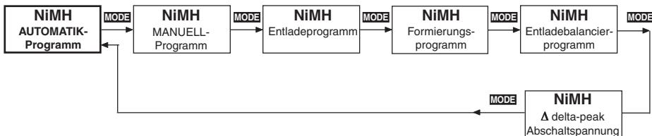
Komfortable Ladeprogramme für die Aufladung von im Modellbau üblichen Nickel-Metall-Hydrid-Akkus. Ist das Lade-/Entlade-Programm beendet, so erscheint bis zum Abklemmen des Akkus das Ladeprogramm abwechselnd mit dem Schriftzug “\*ENDE\*” im Display, die Ladezeit, der letzte (Ent-)Ladestrom, die
