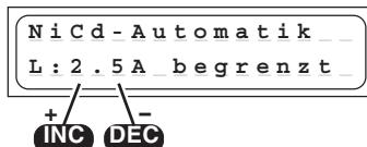
In questo programma il caricabatterie riconosce il tipo di accumulatore collegato e adegua la corrente di carica corretta, in modo da evitare un sovraccarico dell'accumulatore. La corrente di carica massima può essere impostata con i tasti INC / DEC prima di collegare l'accumulatore da 0.1 a 5.0 A senza limitazioni. Il processo di carica termina in accordo con i valori impostati per la tensione di spegnimento del delta peak.
