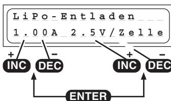
Questo programma serve per es. per determinare la capacità residua di un accumulatore non ancora scarico. Con questo programma la scarica viene effettuata con la corrente di scarica impostata (0,10...1,0 A, a sinistra sul display) fino al raggiungimento della tensione finale di scarica impostata (2,5...3,7 V per cella, a destra sul display). La tensione finale di scarica di 2,5 V per cella non può essere superata, altrimenti l'accumulatore può danneggiarsi.
