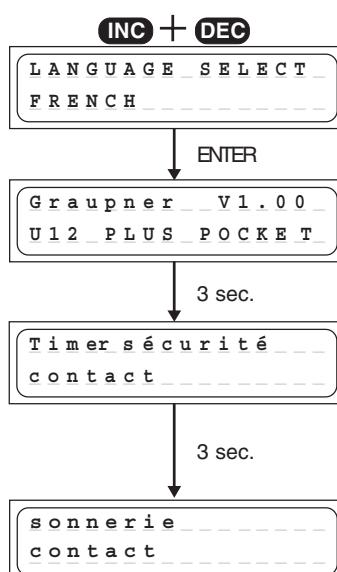
Pressez simultanément les touches INC et DEC pendant que l'appareil est alimenté avec la tension d'entrée pour accéder à la sélection du langage. Pressez la touche INC ou la touche DEC pour sélectionner la langue désirée ENGLISCH = ANGLAIS, GERMAN = ALLEMAND ou FRENCH = FRANÇAIS. Quittez la sélection du langage en pressant la touche ENTER.
