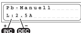
Bei diesem Programm wird **vor** dem Anstecken des zu ladenen Akkus mit den INC / DEC-Tasten der für den Akku maximal zulässige Ladestrom (maximal Ladestrom) eingestellt. Diese Einstellung legt nur die Obergrenze fest, den das Ladegerät dem Akku zumuten darf.
