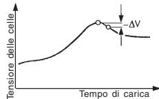
Lo spegnimento automatico del processo di carica (riconoscimento di accumulatore completamente carico) funziona secondo il principio del delta peak, già provato milioni di volte e noto anche come delta-U o delta-V. In questo procedimento viene valutata la tensione massima della curva di carica, che indica con molta precisione la massima carica immagazzinata.
