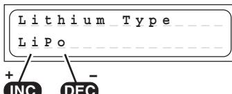
(LiPo, Lilo ou LiFe) influence la tension de coupure. Si un accu au Lithium n'est rechargeé qu'au 2/3 de sa capacité, c'est qu'un mauvais type d'accu a été réglé.
