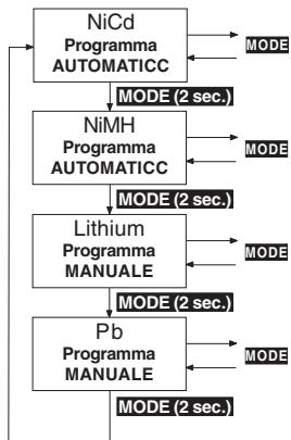
Le possibilità di carica e scarica dell'ULTRAMAT 12 PLUS sono suddivise in modo chiaro e logico in quattro gruppi di programmi. Per i diversi tipi di accumulatori : Nichel-Cadmio, Nichel-Metal Idrato, Ioni di litio / Polimeri di litio / LiFePO<sub>4</sub> (LiFe) e Piombo c'è a disposizione un proprio gruppo di programmi.
