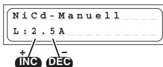
Con questo programma potete caricare il vostro accumulatore con la corrente impostata. La corrente massima può essere impostata prima di collegare l'accumulatore con i tasti INC / DEC da 0.1 a 5.0 A. Il processo di carica termina in accordo con i valori impostati per la tensione di spegnimento del delta peak.
