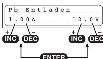
Questo programma serve per es. per determinare la capacità residua di un accumulatore di alimentazione di un motore.
