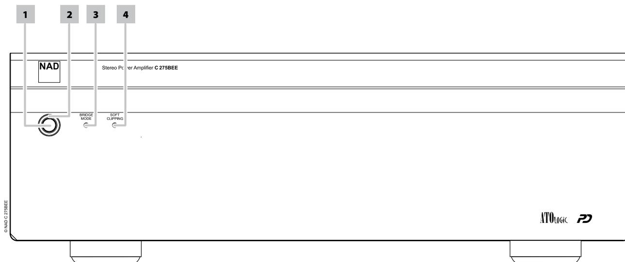
**1 BOUTON STANDBY (VEILLE) :** appuyez sur ce bouton pour allumer le C 275BEE. Le voyant à LED Standby (Veille) passe de la couleur jaune à la couleur bleue. Une nouvelle pression sur ce bouton fait repasser l'appareil en mode Standby (Veille).
