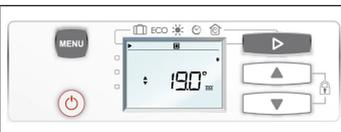
La température de fonctionnement est de 7° C, pendant toute la durée d'aération de votre pièce. A la fermeture de la fenêtre, votre radiateur reprendra son fonctionnement initial.
