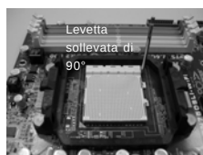
FASE 1: Sollevare la levetta socket
