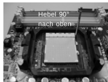
SCHRITT 1: Ziehen Sie den Sockelhebel hoch
