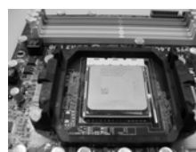
FASE 4: Abbassare e bloccare la levetta socket
