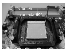
PASO 1: Levante la Palanca del Zócalo
