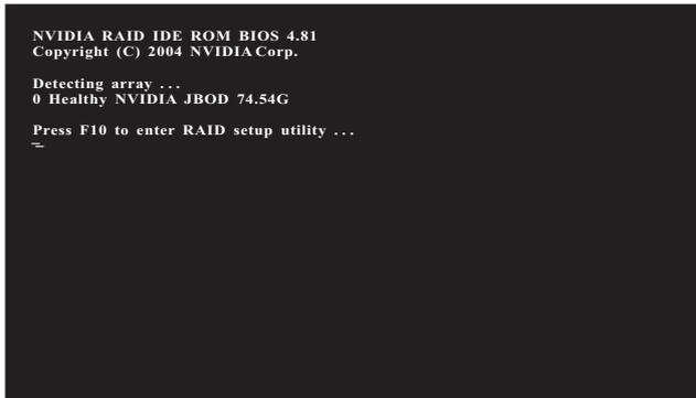
Après redémarrage de l'ordinateur, attendez que le logiciel RAID vous demande d'appuyer sur <F10>. Le message RAID qui apparaît fait partie des processus d'autotest et de démarrage système avant de lancer le système d'exploitation. Vous avez quelques secondes pour appuyer sur <F10> avant que la fenêtre disparaisse.
