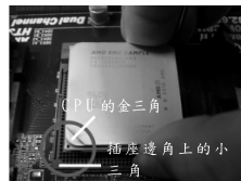
步驟 2 / 步驟 3： 將 CPU 的金三角對準插座 邊角上的小三角
