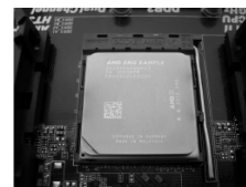
FASE 4: Abbassare e bloccare la levetta socket
