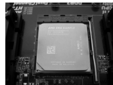
步驟 4： 下推並鎖住插座拉桿
