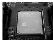
ШАГ 4. Прижмите и зафиксируйте рычаг гнезда.
