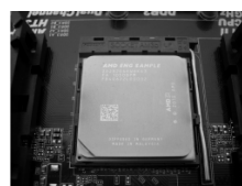
FASE 4: Abbassare e bloccare la levetta socket
