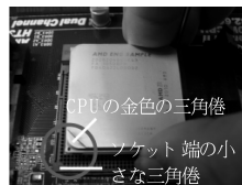
ステップ 2 / ステップ 3 CPU の金色の三角角をソケット端の小さな三角角に合わせます
