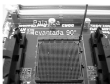
PASO 1: Levante la Palanca del Zócalo
