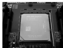
ШАГ 4. Прижмите и зафиксируйте рычаг гнезда.
