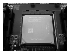
步驟4： 下推並鎖住插座拉桿
