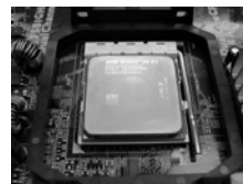
步骤 4： 下推并锁住插座拉杆
