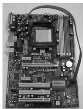
将 SATA 数据线连接到 eSATAII 接口 (eSATAII_TOP)
