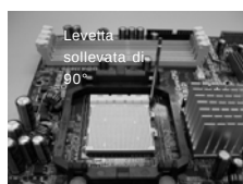
FASE 1: Sollevare la levetta socket
