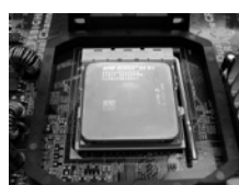
FASE 4: Abbassare e bloccare la levetta socket
