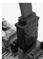
将 SATA 数据线连接到红色的 SATAII 接口(SATAII_RED (PORT 1))
