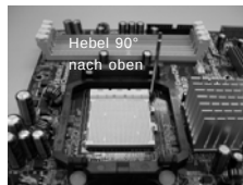
SCHRITT 1: Ziehen Sie den Sockelhebel hoch
