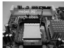
SCHRITT 1: Ziehen Sie den Sockelhebel hoch
