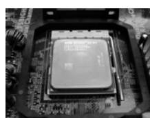
FASE 4: Abbassare e bloccare la levetta socket
