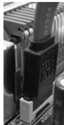
Collegare il cavo dati SATA al connettore eSATAII (eSATAII_TOP)
