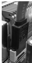
SATA データケーブルを eSATAII コネクタ (eSATAII_TOP) に接 続します
