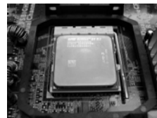
ステップ 4 ソケットレバーを押下げてロックします
