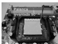
PASO 1: Levante la Palanca del Zócalo
