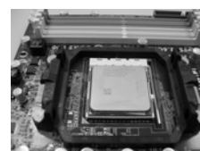
FASE 4: Abbassare e bloccare la levetta socket
