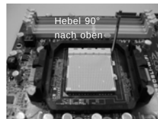
SCHRITT 1: Ziehen Sie den Sockelhebel hoch
