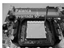
PASO 1: Levante la Palanca del Zócalo
