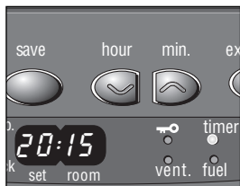
H: Kontrollampen TIMER angiver, at TIMER funktionen er aktiveret.
