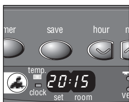
G: Links die eingestellte Temperatur, rechts die tatsächliche Temperatur.
