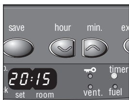
H: La lampe témoin TIMER indique que la fonction timer est active.
