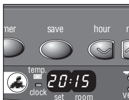
G: A la izquierda la temperatura deseada, a la derecha la temperatura existente
