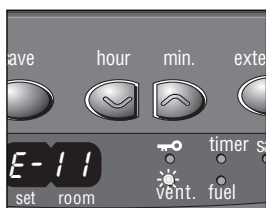
L: Se la spia luminosa VENT lampeggia, significa che occorre una maggiore ventilazione.
