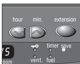
J: Als het lampje SAVE oplicht, slaat de kachel automatisch aan en uit, om binnen een bepaald temperatuurbereik te blijven.
