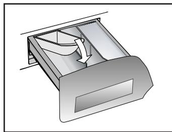
Ce bac doit être introduit dans la section “2” du tiroir à lessive, également lorsque l’on désire utiliser le programme “RINÇAGES” comme cycle de BLANCHISSAGE.
