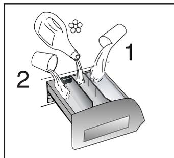
Si vous souhaitez utiliser une lessive liquide, un récipient spécial peut être inséré dans la section “2” du tiroir à lessive. Grâce à ce système, la lessive s’écoulera dans le tambour seulement au bon moment.
