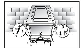
a) Tourner dans le sens des aiguilles d'une montre l'écrou de façon à déverrouiller la vis du pied.
