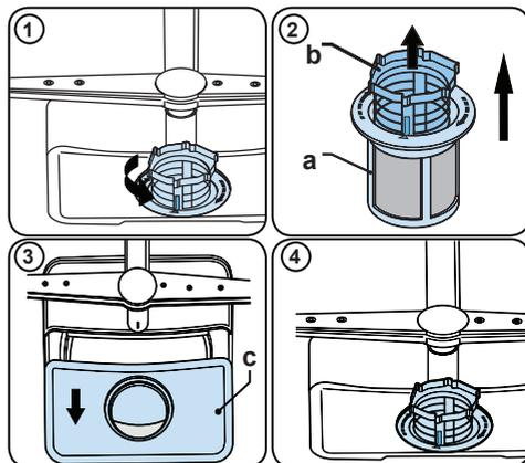
Pour enlever et nettoyer les filtres, tournez le filtre b dans le sens inverse des aiguilles d'une montre et retirez-le en le soulevant (1). Retirez le gros filtre du micro filtre (2). Tirez le filtre métallique, puis retirez-le (3). Rincez les filtres en utilisant beaucoup d'eau jusqu'à ce qu'il n'y ait plus de résidus. Remettez les filtres ensemble. Remplacez l'insert du filtre, et faites-le pivoter dans le sens des aiguilles d'une montre (4).
