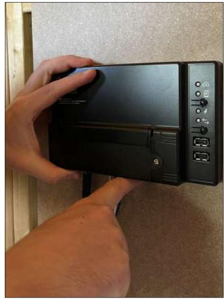
10. 4. Utilisez le rail DIN fourni avec la passerelle de communication et fixez-le à l'aide de vis adaptées au support de destination.
