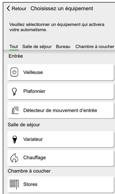
8. Dans Contrôle de l'équipement, enregistrez l'état de l'équipement qui déclenchera l'automatisme. (p. ex. détection de mouvement) et appuyez sur **Définir**.
