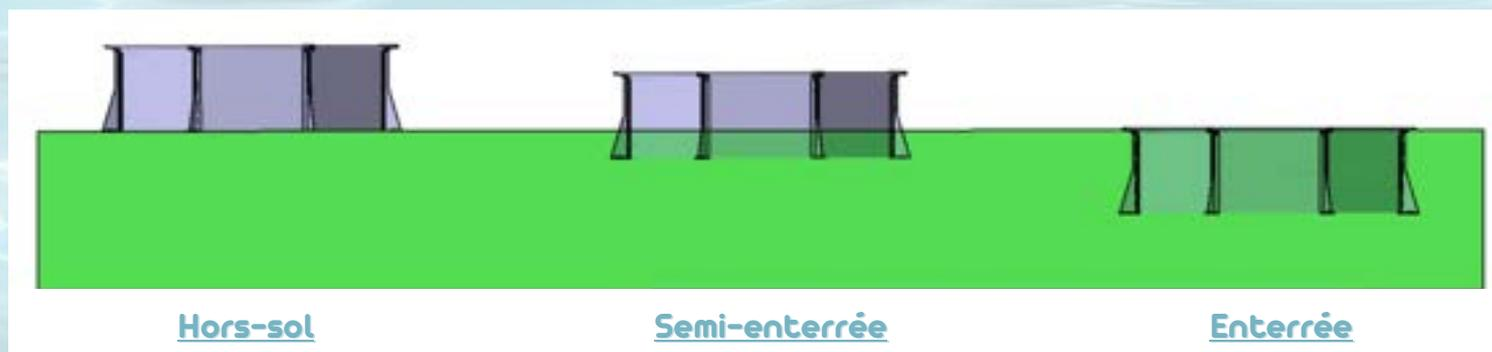
Veillez à ne pas installer votre piscine sur sol récemment remblayé et/ou non stabilisé. Il est nécessaire de décaiser votre terrain et de mettre le terrassement de niveau.
