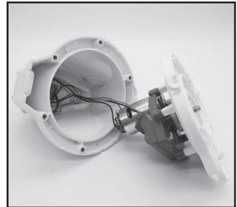
3. Sortir la batterie pour exposer la PCBA. Pour détacher le fil de connexion de la batterie, appuyer sur le clip du connecteur, puis le retirer. REMARQUE: Envelopper le connecteur immédiatement avec du ruban isolant afin d'éviter les court-circuits causés par le contact des deux bornes.
