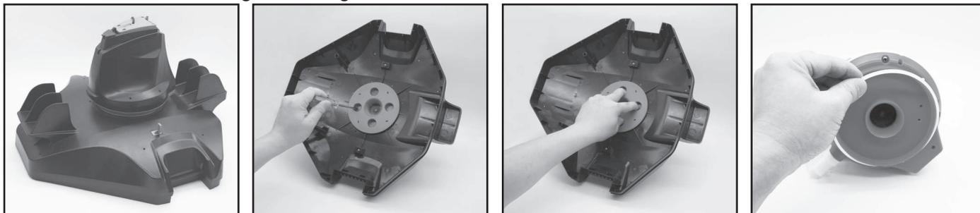
2. Lösen Sie mit dem Schraubenzieher die 4 Schrauben an der Unterseite des Schwenkkopfs, um die Platte zu entfernen. Mit dem Schraubenzieher alle Schrauben wie gezeigt lösen. Den Laufrad entfernen und anschließend nach oben ziehen und entfernen, so dass der Kopf zugänglich ist.
