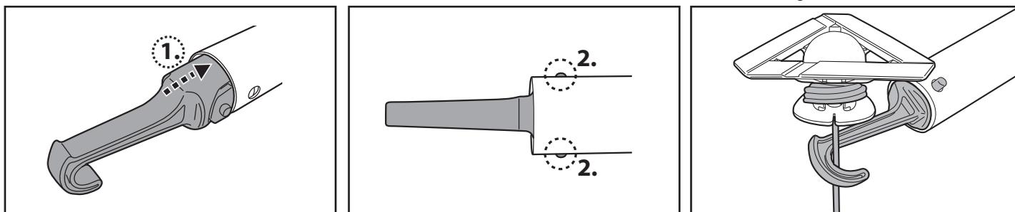
Sobald der Roboter die Wasseroberfläche erreicht, lokalisieren Sie den Griff, der sich unter dem Gehäuse befindet und mit dem Handsymbol gekennzeichnet ist (siehe Abbildung unten), um ihn aus dem Becken herauszuholen. Achten Sie darauf, den Roboter immer von diesem Ende aus zu greifen, um zu verhindern, dass Schmutz bei der Entnahme zurück in das Becken fällt
