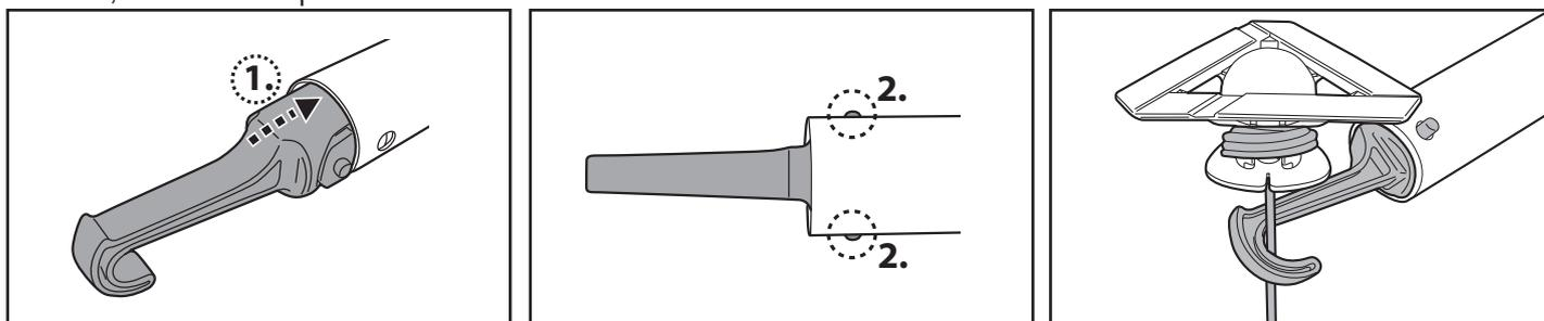
Lorsque le robot atteint la surface de l'eau, vous trouverez la poignée qui se trouve sous la base grâce au symbole du schéma ci-dessous. Assurez-vous de toujours saisir le robot de cette extrémité afin d'éviter que les débris ne retombent dans la piscine.
