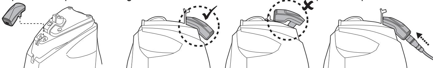
3. Steek de externe adapter in een stopcontact. Het indicatielampje op de externe adapter wordt rood als het laden begint. Het indicatielampje op de externe adapter wordt groen wanneer de robot is opgeladen.
