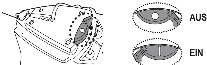
2. Öffnen Sie die Schutzkappe. Richten Sie den Ladestecker aus und schließen Sie es an den Ladeanschluss an.
