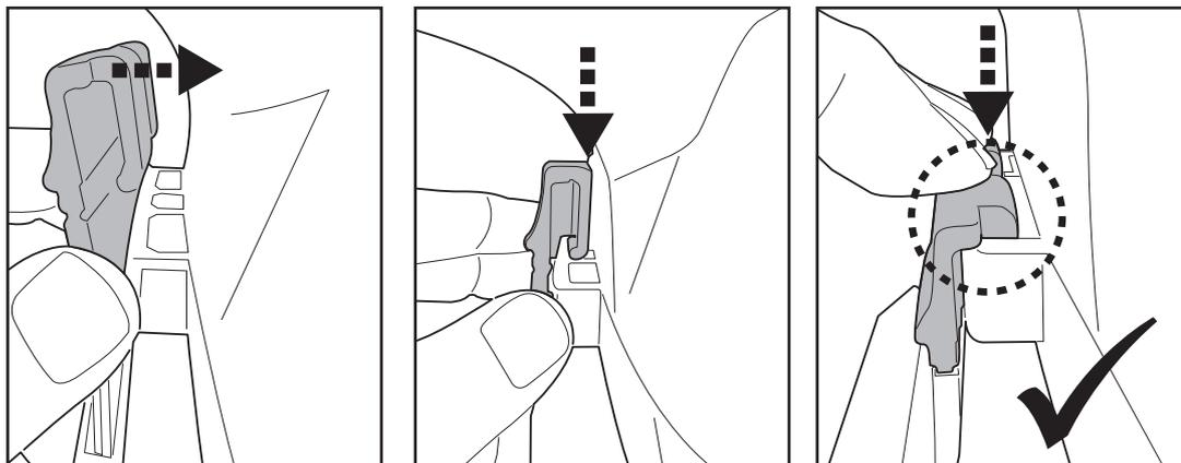
**TIPP:** Die beiden Hakenenden drücken, um den Bürste zu entfernen.
