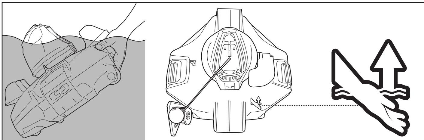
5. Positionner l'interrupteur sur la position OFF. Rincer le robot avec de l'eau fraîche après chaque utilisation. Ne PAS utiliser de détergent.
