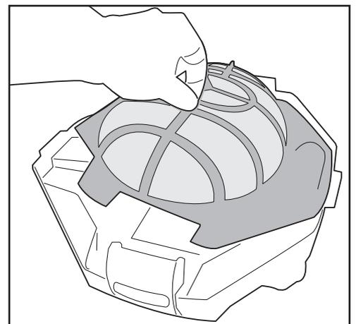
2. Bauen Sie die Filterabdeckung heraus und entfernen Sie den Schmutz aus dem Behälter. Es wird empfohlen, das Filterabdecksieb mit laufendem Wasser zu reinigen. Sollte das Sieb gebürstet werden müssen, verwenden Sie ausschließlich eine weiche Bürste und reinigen Sie es vorsichtig und sanft, um es nicht zu beschädigen.
