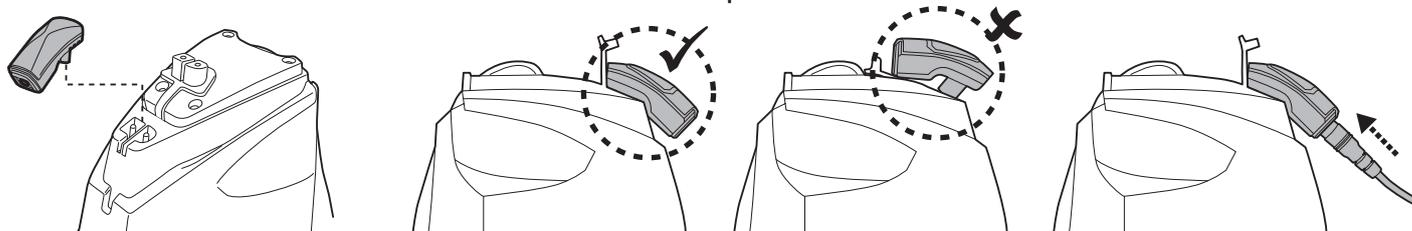
3. Verbinden Sie den externen Adapter mit der Stromquelle. Die Anzeileuchte am externen Adapter leuchtet rot, sobald der Ladevorgang beginnt. Die Anzeileuchte am externen Adapter leuchtet grün, wenn der Roboter aufgeladen ist.
