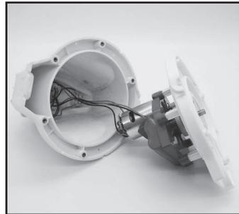
3. Estrarre la batteria per esporre il PCBA. Per estrarre il cavo di connessione della batteria, premere il gancio sul connettore ed estrarlo. **NOTA:** Avvolgere immediatamente il connettore con nastro isolante per evitare corto circuiti provocati dal contatto di entrambi i terminali dei cavi.
