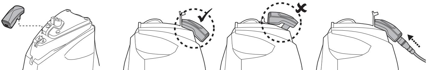
3. Conecte el adaptador externo a la fuente de alimentación. El indicador LED del adaptador externo se vuelve rojo después de que comienza la carga. El indicador LED del adaptador externo se vuelve verde cuando el robot está cargado.
