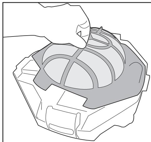
2. Retire el filtro y vacíe la suciedad del compartimento. Se recomienda limpiar la malla del filtro con agua. Si requieren cepillado, utilice un cepillo suave y límpielas con delicadeza para evitar deteriorarlas.
