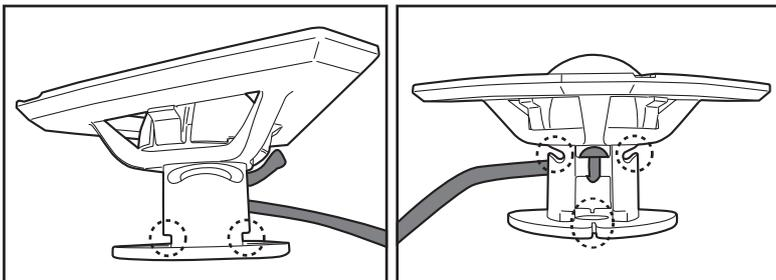
Die korrekte Länge des Seils sollte dem Abstand zwischen der Oberkante des Roboters und dem Wasserspiegel entsprechen. **HINWEIS:** Überlänge kann das Seil knicken und dadurch die Leistung beeinträchtigen.
