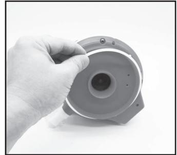
2. Utiliser le tournevis pour dévisser les 4 vis situées en dessous de la tête pivotante pour retirer la plaque inférieure. Utiliser le tournevis pour dévisser toutes les vis de la base comme indiqué. Retirer la turbine, puis soulever la base et la retirer pour exposer la partie intérieure.
