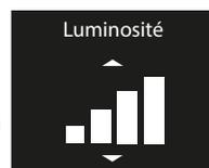
Le menu «Luminosité» permet de régler l'intensité lumineuse diffusée par l'appareil, sur 4 niveaux.
