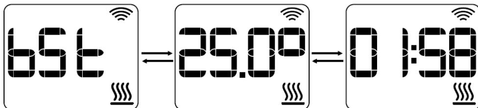
Si vous souhaitez terminer avant l'heure définie, appuyez sur la touche **Config/Pr**. L'appareil reviendra au mode de fonctionnement sélectionné, avant le mode Boost.
