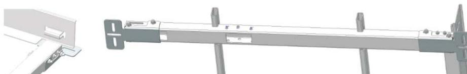
Détail du montage latéral, les profils de support sont insérés dans les supports de base :
