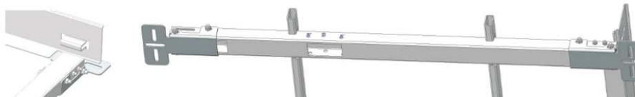
Detalle del montaje lateral, los perfiles de soporte se insertan en los soportes base:
