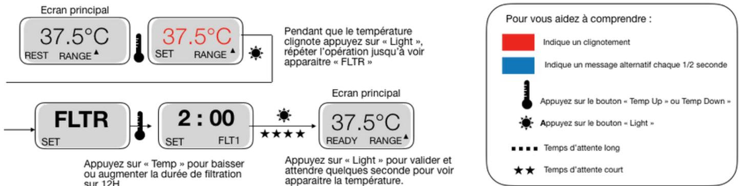
Quand le cycle de filtre 2 est activé, « Filter 12 » apparaitra sur l'écran. Si le filtre n'est pas activé, « Filter 1 » apparaitra.
