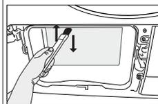
Les peluches collectées sur la surface du condenseur doivent être enlevées avec un chiffon humide ou en frottant la brosse placée sur le couvercle d'acheminement de l'air de haut en bas sur le condenseur.
