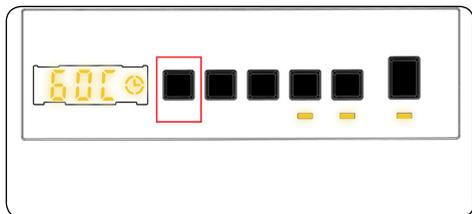
Lorsqu'un programme est sélectionné, la température maximale de ce dernier est automatiquement sélectionnée. Pour ajuster cette dernière, appuyer sur la touche de réglage de la température de l'eau jusqu'à ce que la valeur maximale souhaitée s'affiche sur l'écran numérique.
