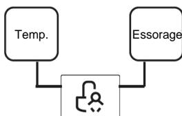
Appuyez simultanément sur Température et Essorage pendant 3 secondes, jusqu'à ce que le bip sonore retentisse.
