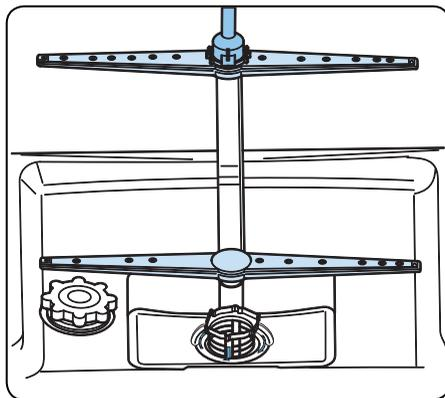
Pour enlever et nettoyer la combinaison du filtre, tournez cette dernière dans le sens inverse des aiguilles d'une montre et retirez-la en la soulevant (1). Retirez le gros filtre du micro filtre (2). Tirez le filtre métallique, puis retirez-le (3). Rincez le filtre en utilisant beaucoup d'eau jusqu'à ce qu'il n'y ait plus de résidus. Remettez les filtres ensemble. Remplacez l'insert du filtre, et faites-le pivoter dans le sens des aiguilles d'une montre (4).
