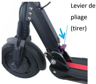
4. Important : Poussez le guidon vers l'avant, appuyez sur le bouton de rabattement avec le pied dans le sens de la flèche dans la figure ci-dessus.
