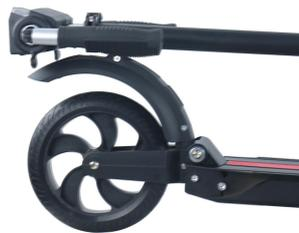
5. Continuez à plier le scooter jusqu'à ce que le crochet pliant atteigne et accroche le boulon situé sur le frein arrière.
