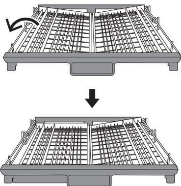
Soulevez la partie gauche du panier, ajustez la partie gauche du panier en position basse; la partie gauche du panier est à plat et la partie droite est oblique.
