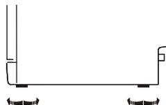
Une fois l'appareil installé dans son emplacement, vous pouvez ajuster la hauteur du lave-vaisselle en réglant le niveau des pieds. Dans tous les cas, l'appareil ne doit pas être incliné à plus de 2°.
