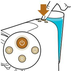
8 O botão para Ristretto apresenta uma intermitência rápida. Prima o botão para Ristretto para ativar o ciclo de descalcificação. A máquina distribui a solução de descalcificação completa em intervalos regulares. O processo demora até 30 minutos.
