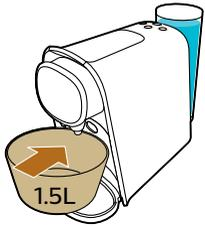
6 Placez un bol pouvant contenir au moins 1,5 litre sur le plateau égouttoir inférieur, sous la buse de distribution de café, pour recueillir la solution de détartrage.
