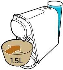
6 Coloque um recipiente com uma capacidade mínima de 1,5 litros no tabuleiro de recolha de pingos inferior sob o bico de distribuição do café para recolher a solução de descalcificação.
