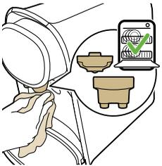
2 Limpie la parte frontal del aparato con un paño húmedo y limpie las dos piezas de la boquilla dispensadora de café (las salidas de café y la tapa de la boquilla) bajo el grifo con agua caliente o en el lavavajillas.
