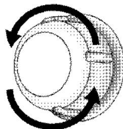
3. Если в вашей духовке используется лампа типа (А), показанная на рисунке ниже, поверните ее в соответствии с рисунком, чтобы извлечь ее и заменить. Если используется лампа типа (В), потяните и извлеките ее, как показано на рисунке, и замените.
