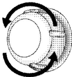
3. Si la lampe de votre four est de type (A) comme l'indique le schéma ci-après, ôtez-la en la faisant pivoter comme illustré, avant de la remplacer. Si, par contre, elle est de type (B), tirez-la pour l'ôter comme illustré sur le schéma avant de la remplacer.
