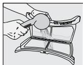
Une couche peut se former sur les pores du filtre et entraîner un bouchage du filtre après avoir utilisé la machine pendant un certain temps. Lavez le filtre à l'eau chaude pour enlever la couche qui se forme sur la surface du filtre. Séchez le filtre complètement avant de le réinstaller.
