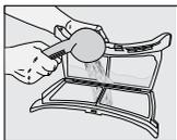
Op de pluisfilterporiën kan, na uw machine enige tijd te gebruiken, een laag ontstaan die verstopping van de pluisfilter kan veroorzaken. Was de pluisfilter met warm water om de opgebouwde laag op het oppervlak van de pluisfilter te verwijderen.
