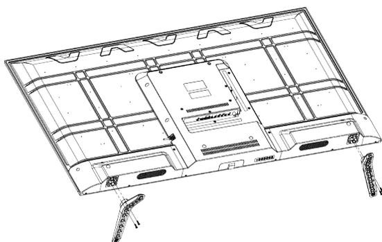
1. Placez le téléviseur avec le panneau orienté vers le bas sur un chiffon doux ou des doublures sur un bureau.
