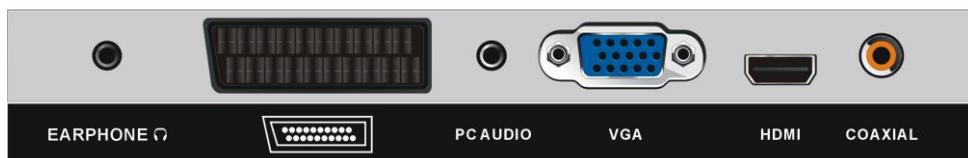
Utilisez un câble coaxial pour connecter un amplificateur audio ou autre appareil de décodage audio pour sortie audio coaxiale. (Le câble coaxial n'est pas fourni)
