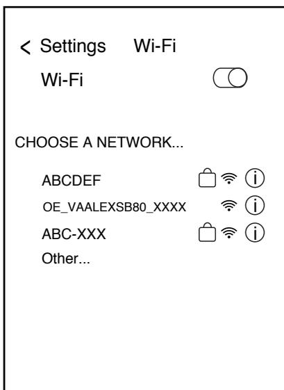
**NOTE:** Appuyez sur "Impossible de trouver OE\_VAALEXSB80\_XXX" si "OE\_VAALEXSB80\_XXX" n'apparaît pas sur la liste Wi-Fi du périphérique. Appuyez sur "Continuer" pour accéder à la page de configuration Wi-Fi du téléphone et maintenez enfoncé le bouton WPS de l'appareil en même temps.
