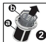
Mit reichlich klarem Wasser spülen. Den Abfallfilter und den Mikrofilter wieder einsetzen und dabei darauf achten, dass die Markierungen übereinstimmen. Setzen Sie die Einheit in den Metall- oder Kunststofffilter und drehen Sie sie in Pfeilrichtung (Uhrzeigersinn); die Einheit ist eingerastet, wenn der Pfeil am Mikrofilter sichtbar ist. **④**
