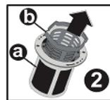
Enjuáguelo bajo el grifo con abundante agua. Vuelva a colocar el filtro de residuos en el microfiltro con cuidado de hacer coincidir las marcas de referencia. Coloque el conjunto en el filtro de metal o plástico y gírelo en el sentido de la flecha (sentido de las agujas del reloj); el conjunto se encuentra bloqueado cuando se ve la flecha en el microfiltro. **④**
