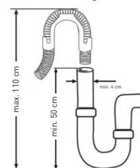
Het is mogelijk een ledigingsslang aan te sluiten op een vaste lediging, of op een speciale aansluiting onder de gootsteen. Met behulp van een speciaal elleboogstuk (indien beschikbaar)
