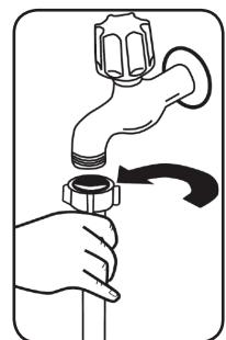
Vooraleer de nieuwe toeverleiding of een slang die lange tijd niet gebruikt werd aan te sluiten op uw vaatwasser, laat u even het water lopen. Sluit de watertoeverleiding handmatig en rechtstreeks aan op de watertoeverkraan. De druk van de kraan dient minstens 0,03 Mpa en maximum 1 Mpa te zijn. Wanneer de waterdruk groter is dan 1 Mpa, plaats dan een drukverminderingstoestel tussen de kraan en de slang.
