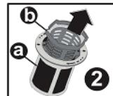
Overvloedig spoelen onder stromend water. Plaats de afvalfilter terug in de microfilter en let er hierbij op de markeringen samen te laten vallen. Plaats het geheel in de filter in metaal of plastic en draai in de richting van de pijl (wijzerzin); alles is vergrendeld wanneer de pijl op de microfilter **4** zichtbaar is.
