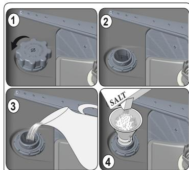
No lo rellene completamente si utiliza sal en pastillas. Le recomendamos utilizar sal en grano o en polvo. **No utilice jamás sal de mesa en su lavavajillas.** En caso contrario, la eficacia del descalcificador podría disminuir con el paso del tiempo. Si el indicador de sal situado en el panel de control se enciende, rellene de nuevo el compartimento de sal.
