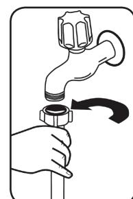
manualmente el tubo de entrada de agua directamente en el grifo de entrada. La presión del grifo debe ser, como mínimo, de 0,03 MPa y, como máximo, de 1 MPa. Si la presión de agua es superior a 1 MPa, instale un dispositivo reductor de presión entre el grifo
