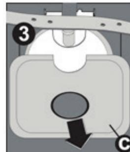
Trekk aan de plastic of metalen filter en verwijder deze **3**. Scheid de afvalfilter vervolgens van de microfilter **2**.
