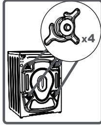
C'est pourquoi, les vis de bridage pour le transport doivent être dévissées par rotation, dans le sens antihoraire, à l'aide d'une clé appropriée.
