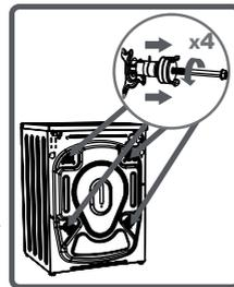
Les vis de bridage pour le transport doivent être stockées afin d'être disponibles dans le cas d'un transport ultérieur.
