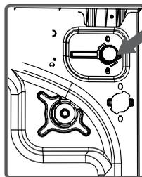
Si la machine n'est pas suffisamment alimentée en eau malgré l'ouverture du robinet, nettoyez ces filtres :
