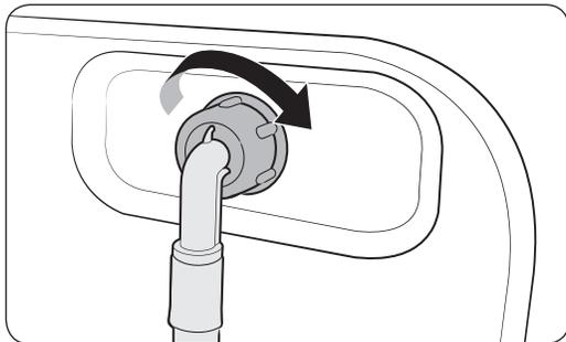
8. Raccordez l'autre extrémité du tuyau d'eau dans la vanne d'alimentation en eau située à l'arrière du lave-linge. Tournez le tuyau dans le sens horaire pour le serrer.
